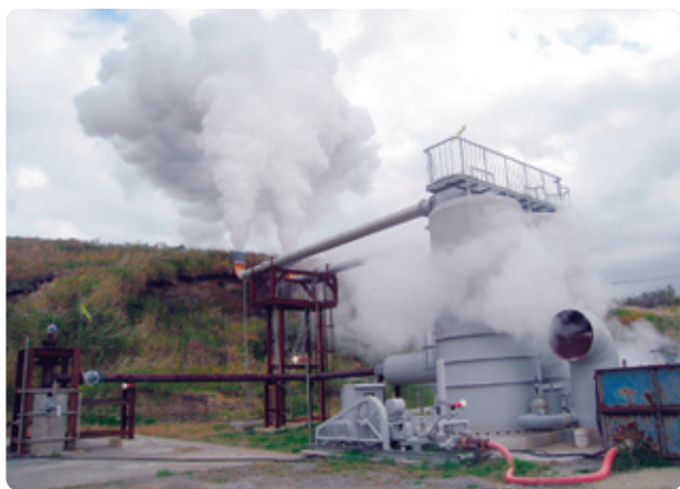
九重町所有の地熱井における噴気試験の様子
