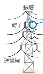
送電用避雷装置は、セラミックの一種である「酸化亜鉛素子」の働きにより、落雷による鉄塔と送電線間の故障(絶縁破壊)を短時間で解消できる装置です。
