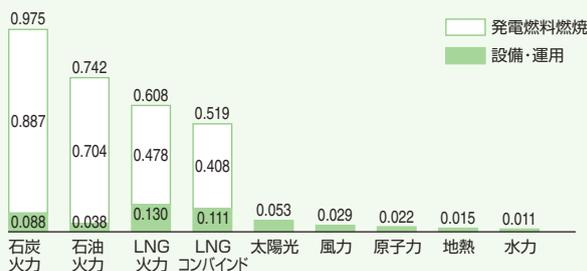
(注) 発電燃料の燃焼に加え、原料の採掘から発電設備等の建設・燃料輸送・精製・運用・保守等のために消費されるすべてのエネルギーを対象としてCO<sub>2</sub>排出量を算定。原子力については、現在計画中の使用済燃料国内再処理・プルトニウム利用(1回リサイクルを前提)・高レベル放射性廃棄物処分等を含めて算出。
