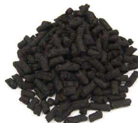
固形燃料化された下水汚泥
