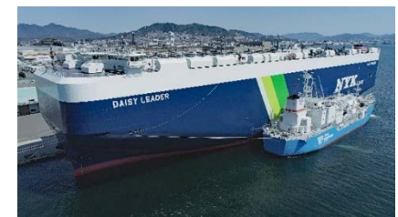
LNGを燃料とする船舶(写真奥)に、LNG燃料を供給するバンカリング船(写真前)
