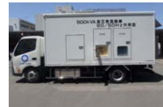
高圧発電機車
