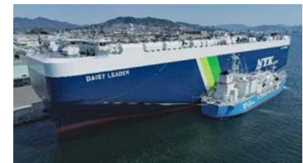
LNGを燃料とする船舶(写真真)に、LNG燃料を供給するバンカリング船(写真真)
