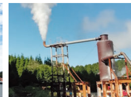
地熱発電所の新規開発地点資源調査 (左：資源確認のための掘削、右：蒸気等能力確認試験)
