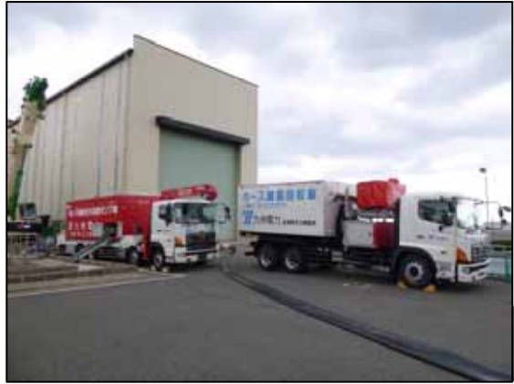
可搬型ポンプによる原子炉冷却のための給水源を確保
