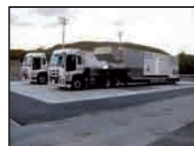
◇ 移動式大容量発電機
