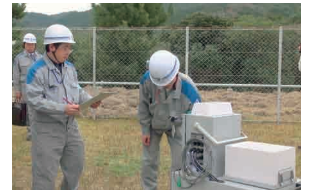
可搬型モニタリング設備を設置し、放射線測定の実施
