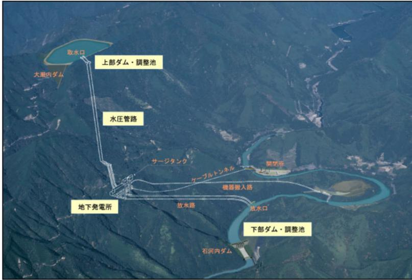
宮崎県児湯郡木城町を流れる一級河川小丸川水系大瀬内谷川に上部ダム(大瀬内ダム)を、小丸川水系小丸川に下部ダム(石河内ダム)を新設し、その間の落差約650mを約2.8kmの水路で連結し、毎秒222m<sup>3</sup>の水を使い、地下に設けた発電所で最大出力120万kWの発電を行う純揚水式発電所です。
