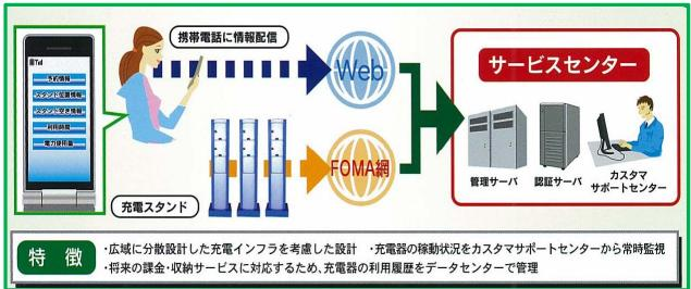
OEV充電スタンドとサービスセンターで構成されており、インターネットまたは携帯電話でQRコードを読み込んだ後にセンターで認証を行い、FOMA網でセンターから充電器を制御します。認証後に通電し、送電ブレーカーや盗電防止装置の動作及び満充電時に自動的に停止する機能を持っています。
