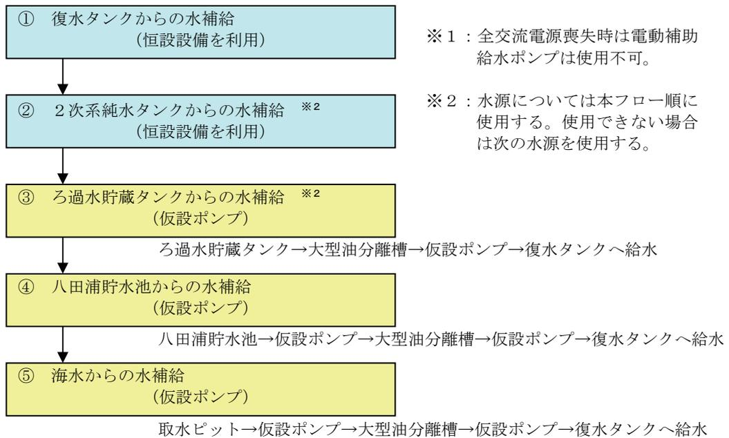
※<sup>1</sup> : 全交流電源喪失時は電動補助給水ポンプは使用不可。
