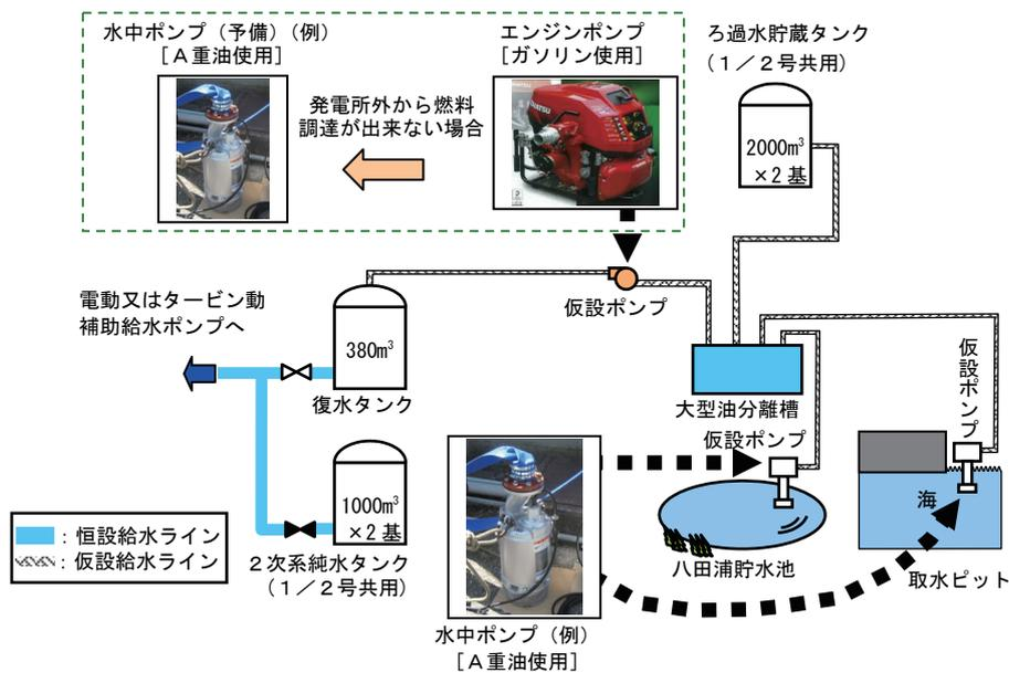
蒸気発生器への補給水源
