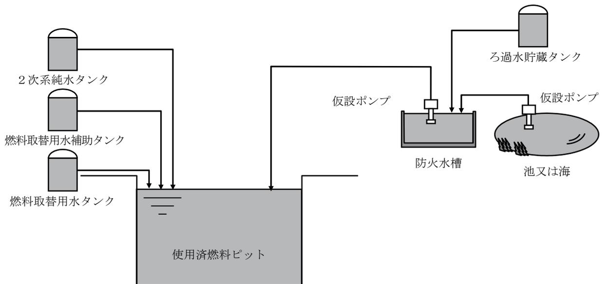
川内1号機 防護措置の整備状況 (炉心損傷防止) (1/2)
