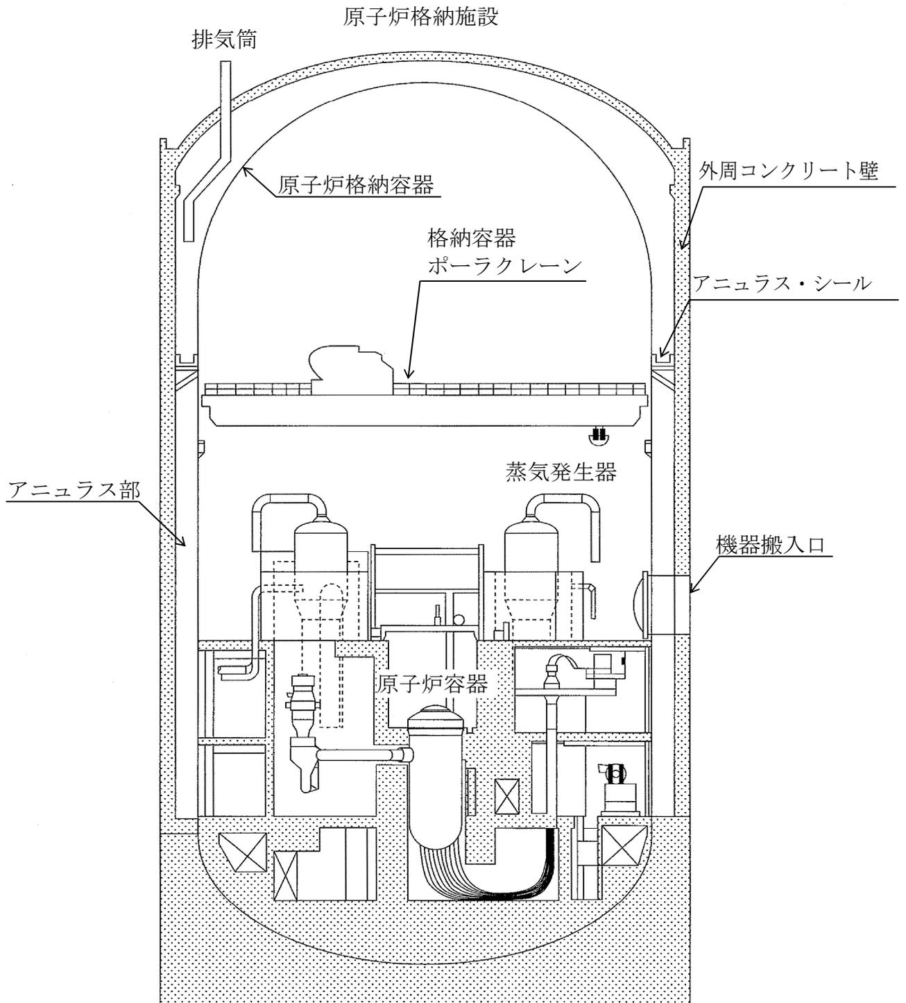
川内1号機の系統構成（原子炉格納容器）
