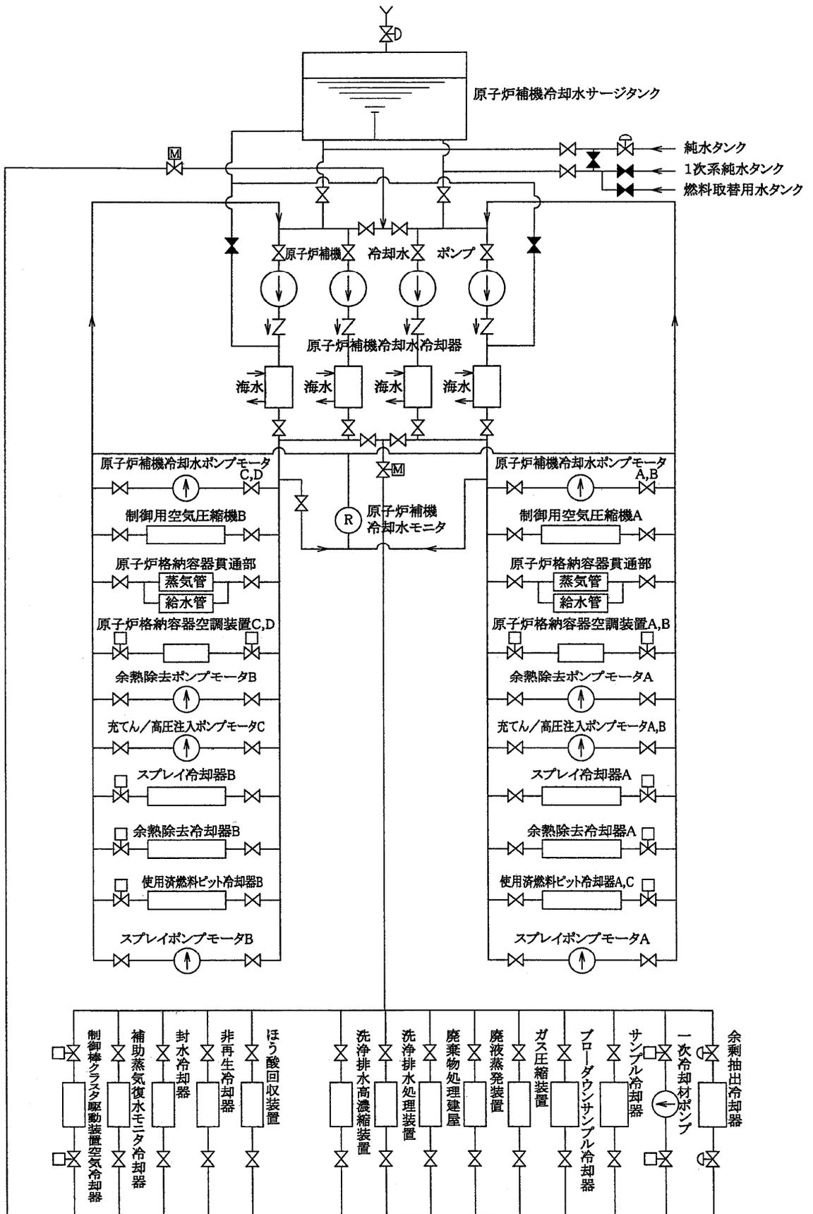
川内1号機の系統構成 (補機冷却水系)
