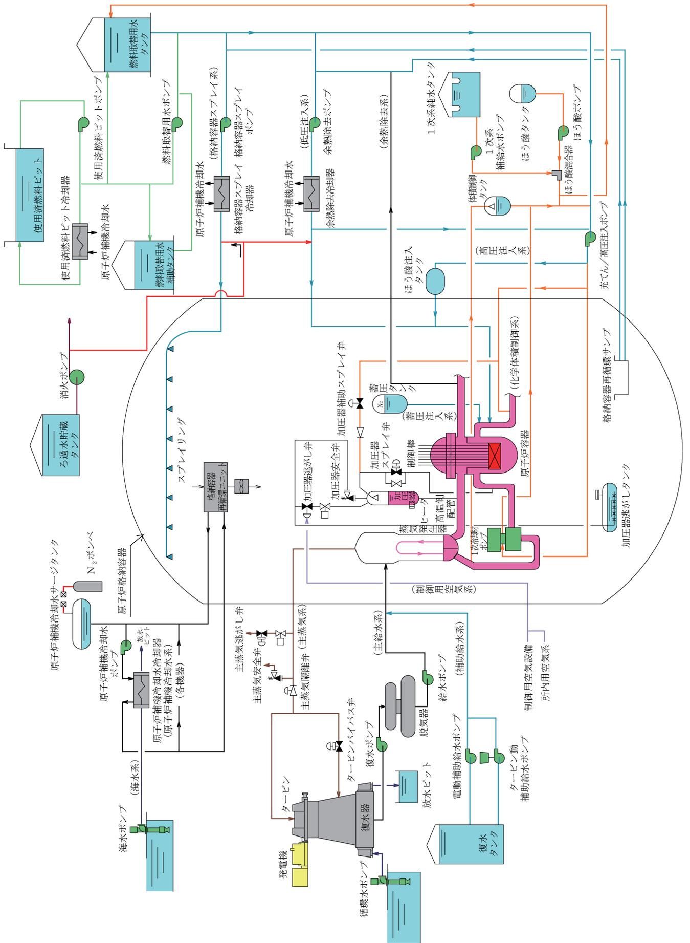
図 2 - 2 川内原子力発電所 1 号機系統概要図
