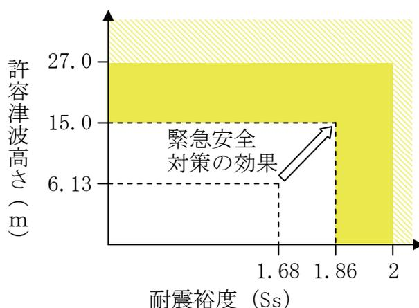
図 5-3-6 地震と津波の重畳に関するクリフエッジ評価結果
