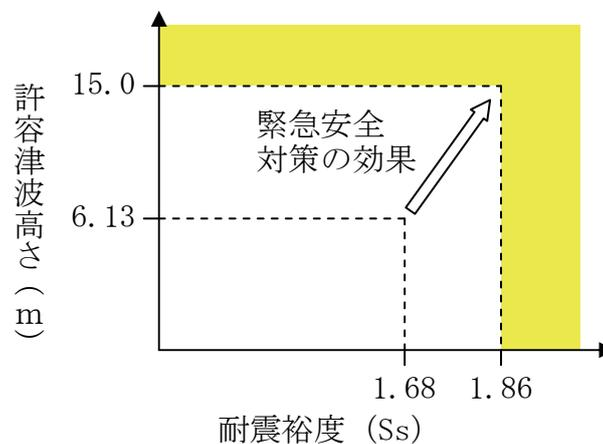
図5-3-3 地震と津波の重畳に関するクリフエッジ評価結果
