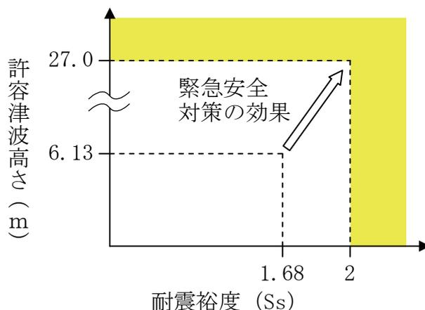
図 5-3-5 地震と津波の重畳に関するクリフエッジ評価結果
