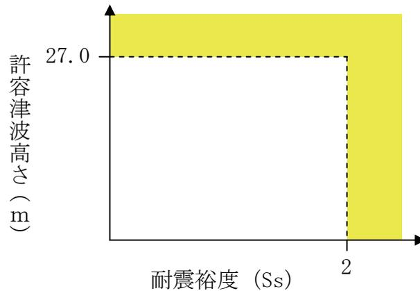
図5-3-4 地震と津波の重畳に関するクリフエッジ評価結果
