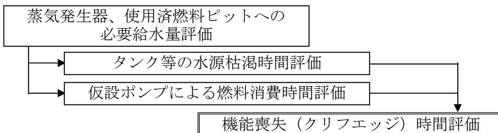
a. プラント運転時の継続時間に係る評価及びクリフエッジの特定
