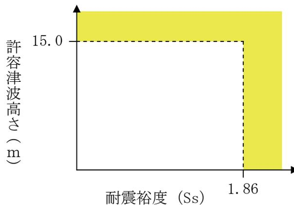
図5-3-2 地震と津波の重畳に関するクリフエッジ評価結果
