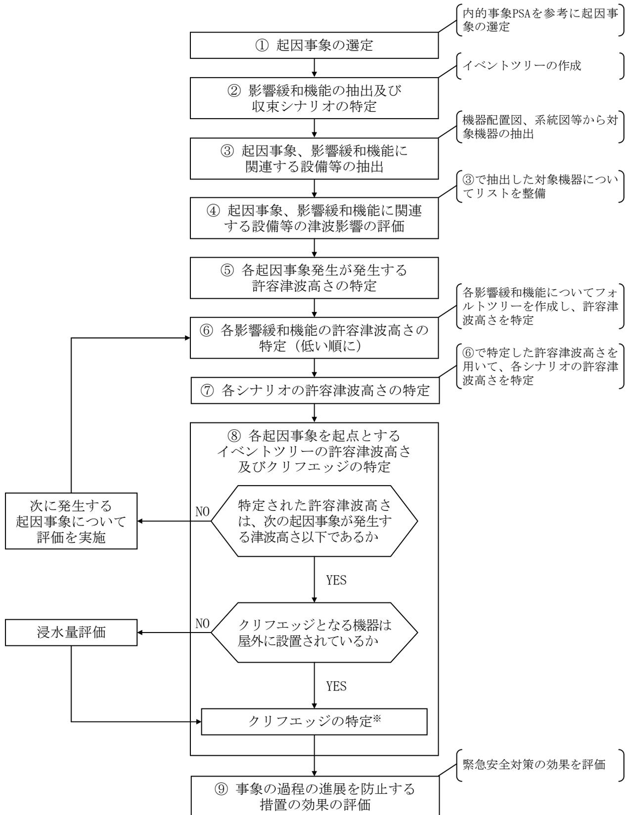
※この時点で評価された許容津波高さのうち、一番低い津波高さをクリフェッジ高さとする。
