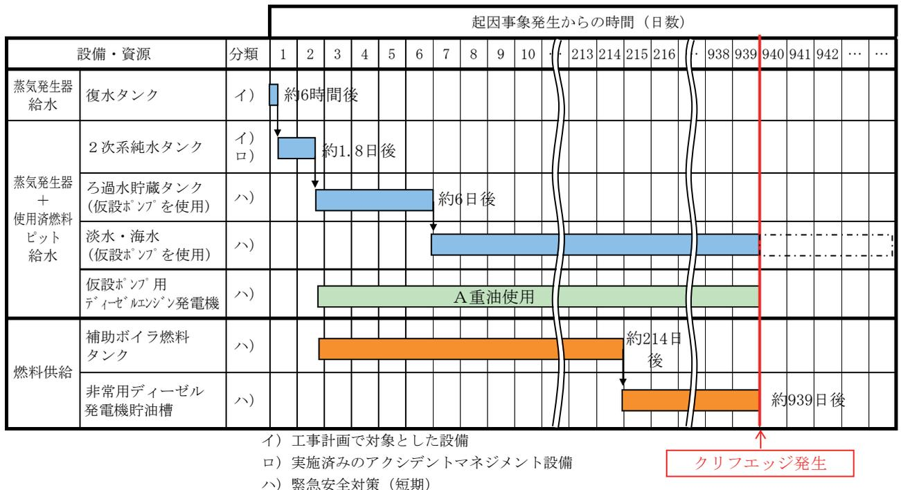
図5-5-3 プラント運転時の給水機能継続時間評価
