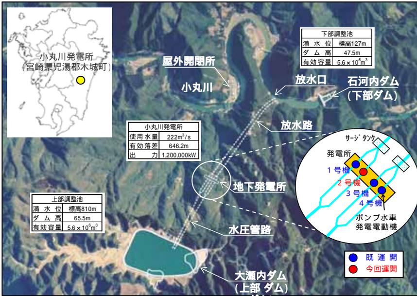
宮崎県児湯郡木城町を流れる一級河川小丸川水系大瀬内谷川に上部ダム(大瀬内ダム)を、小丸川水系小丸川に下部ダム(石河内ダム)を新設し、その間の落差約650mを約2.8kmの水路で連結し、毎秒222立方メートルの水を使い、地下に設けた発電所で最大出力120万kWの発電を行う純揚水式発電所です。
