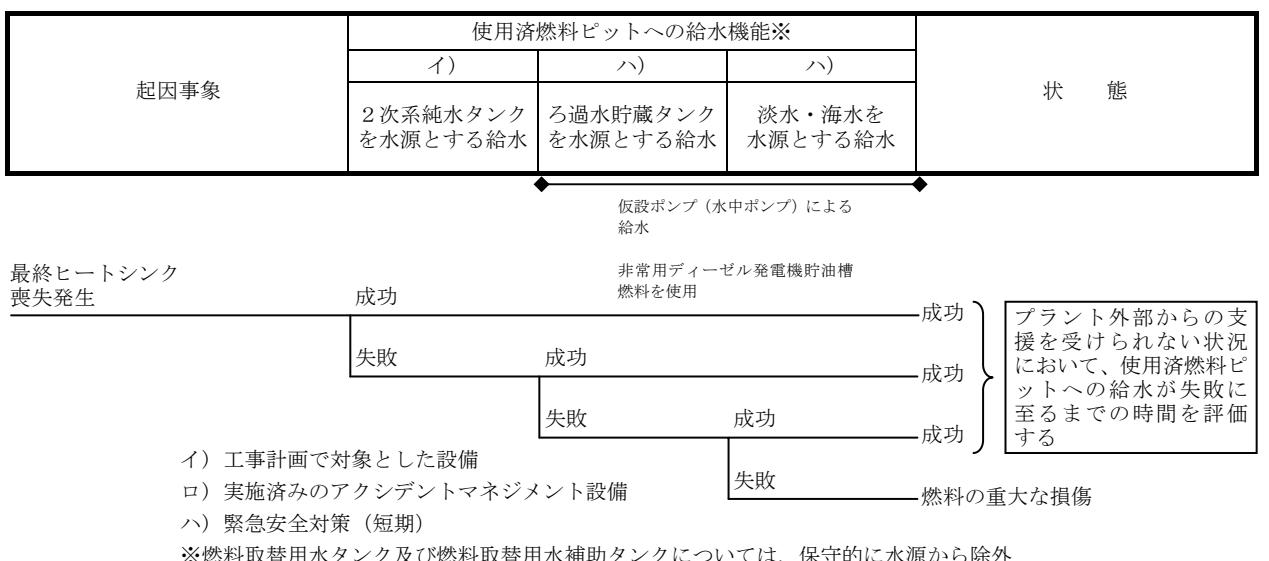
図5-5-2 最終ヒートシンク喪失から燃料の重大な損傷に至る事象の過程(SFP)
