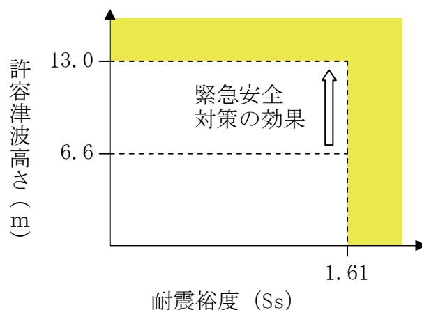
図5-3-3 地震と津波の重畠に関するクリフエッジ評価結果
