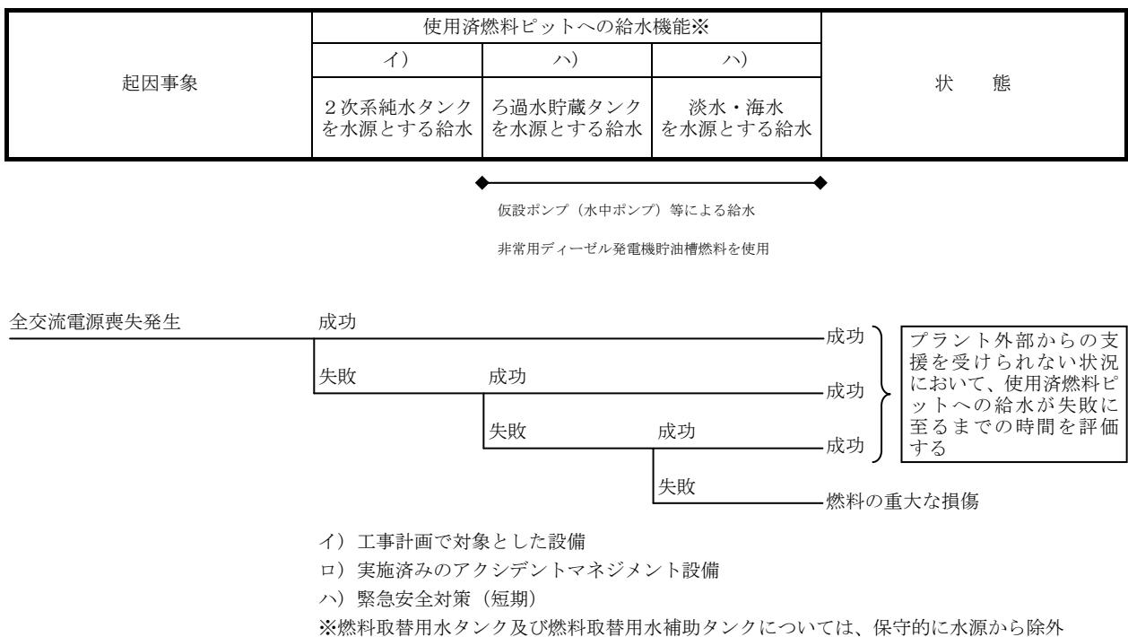
図 5-4-3 全交流電源喪失から燃料の重大な損傷に至る事象の過程（S F P）
