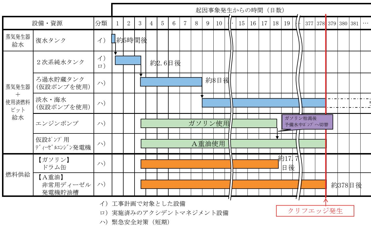
図5－5－3 プラント運転時の給水機能継続時間評価
