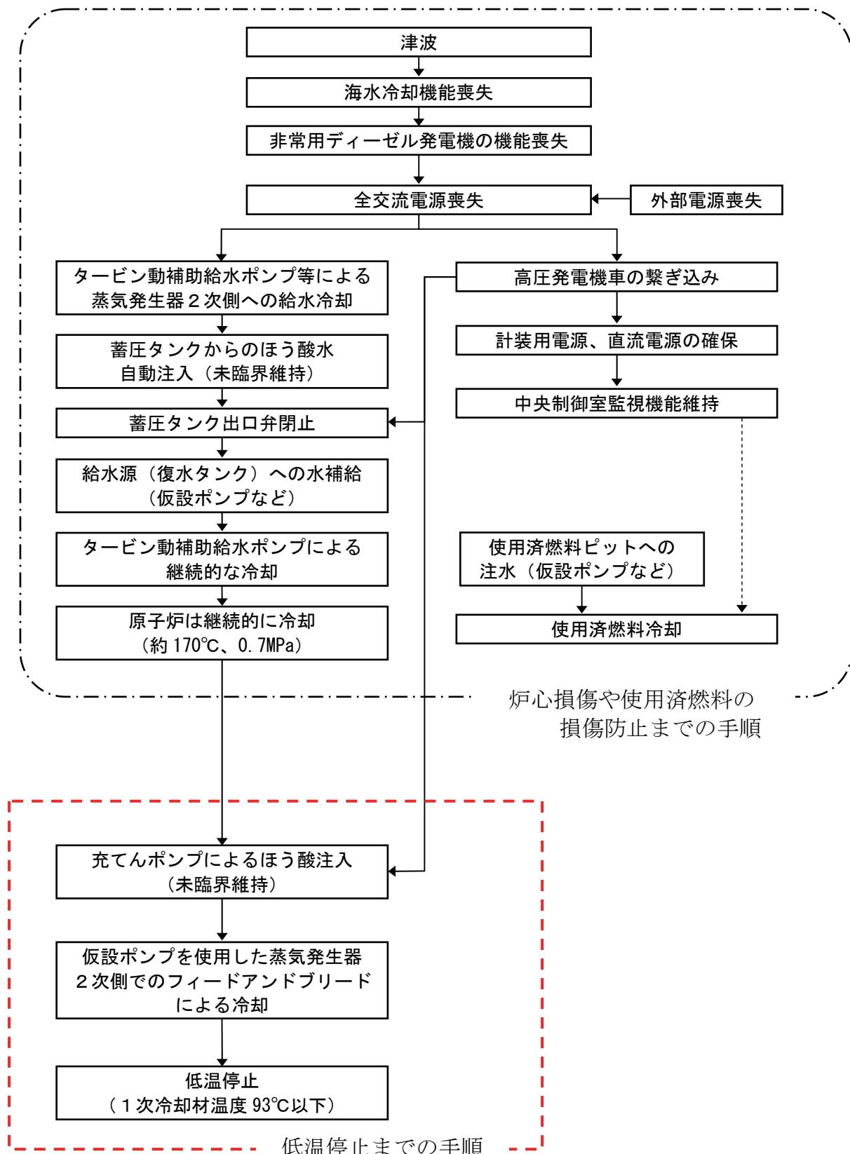
図4－2 原子炉と使用済燃料ピットを継続的に冷却するためのシナリオ
