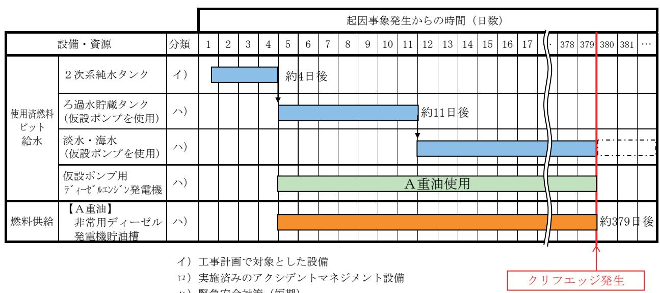
図5-5-4 プラント停止時の給水機能継続時間評価
