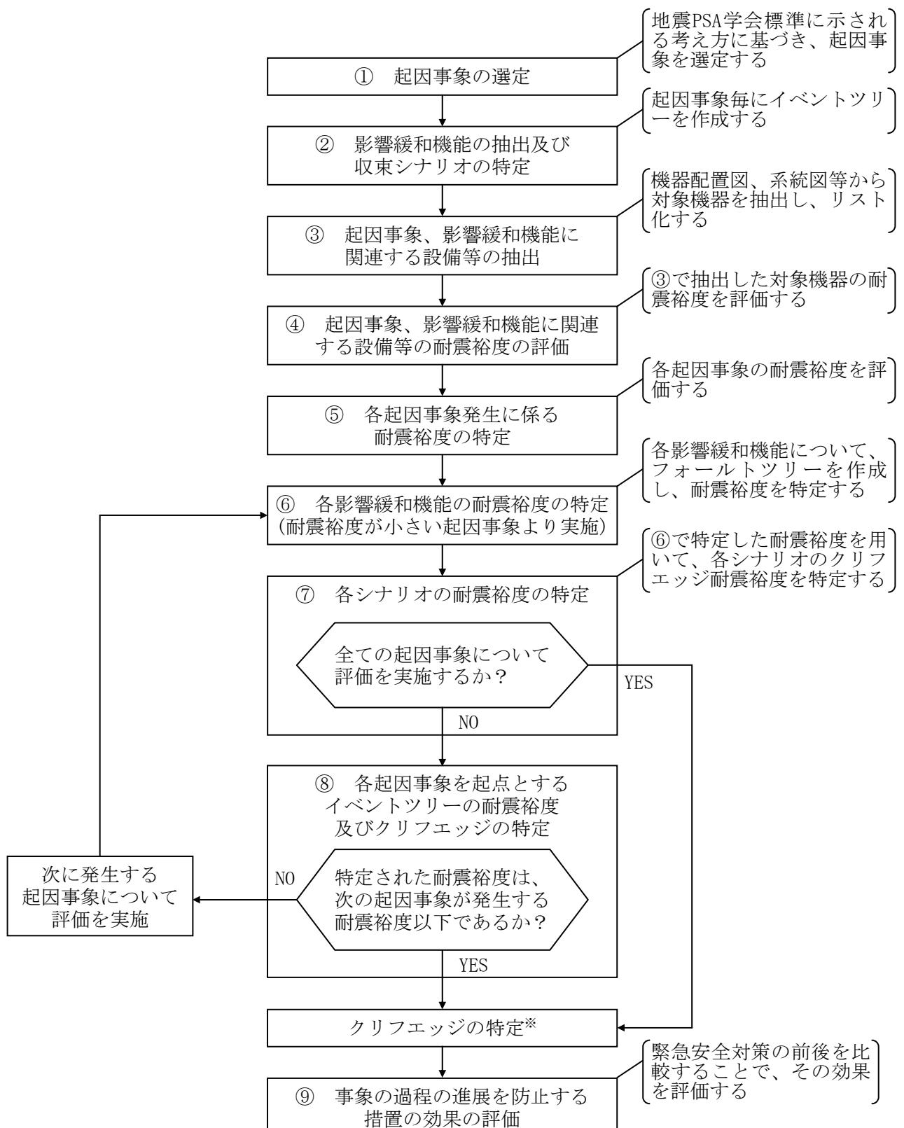
図5-1-1 クリフェッジ評価方法に係るフロー図（地震）
