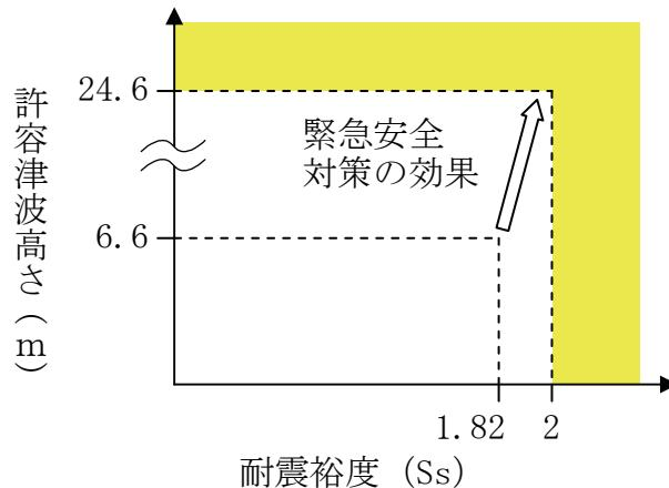
図 5－3－5 地震と津波の重畠に関するクリフェッジ評価結果
