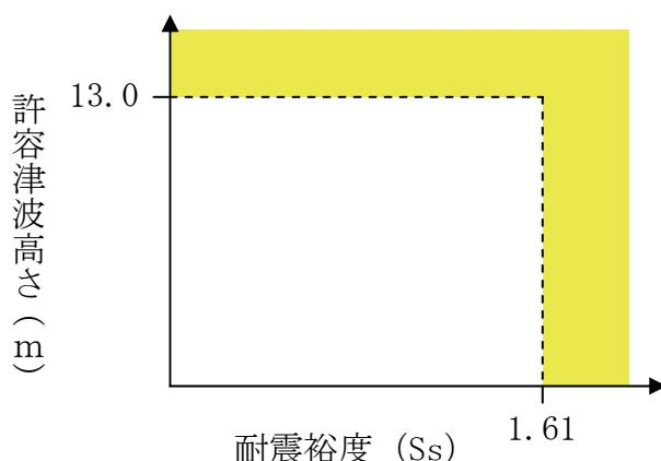
図5-3-2 地震と津波の重畠に関するクリフェッジ評価結果
