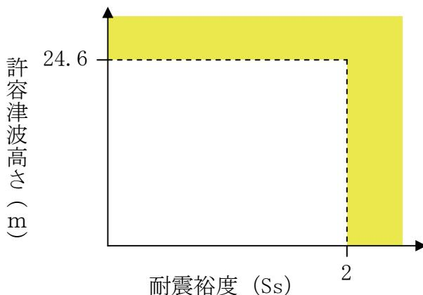
図 5-3-4 地震と津波の重畠に関するクリフェッジ評価結果
