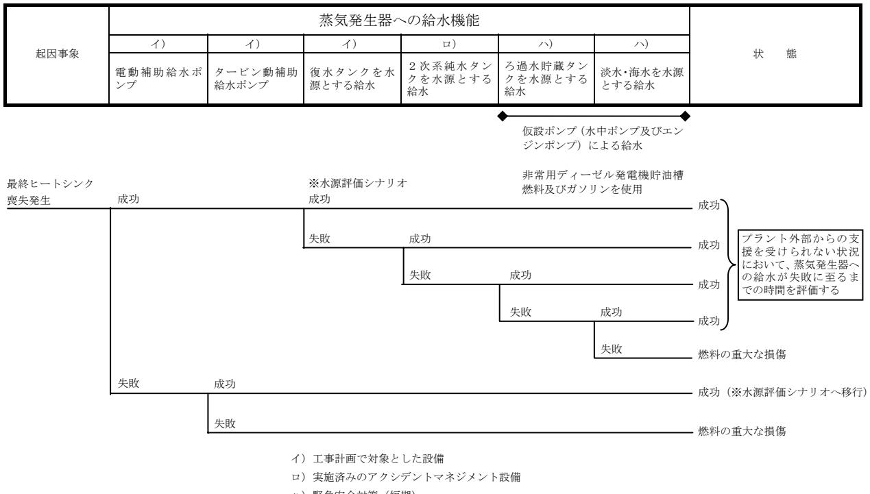
図5-5-1 最終ヒートシンク喪失から燃料の重大な損傷に至る事象の過程(原子炉)
