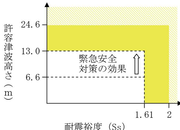
図 5－3－6 地震と津波の重畠に関するクリフェッジ評価結果
