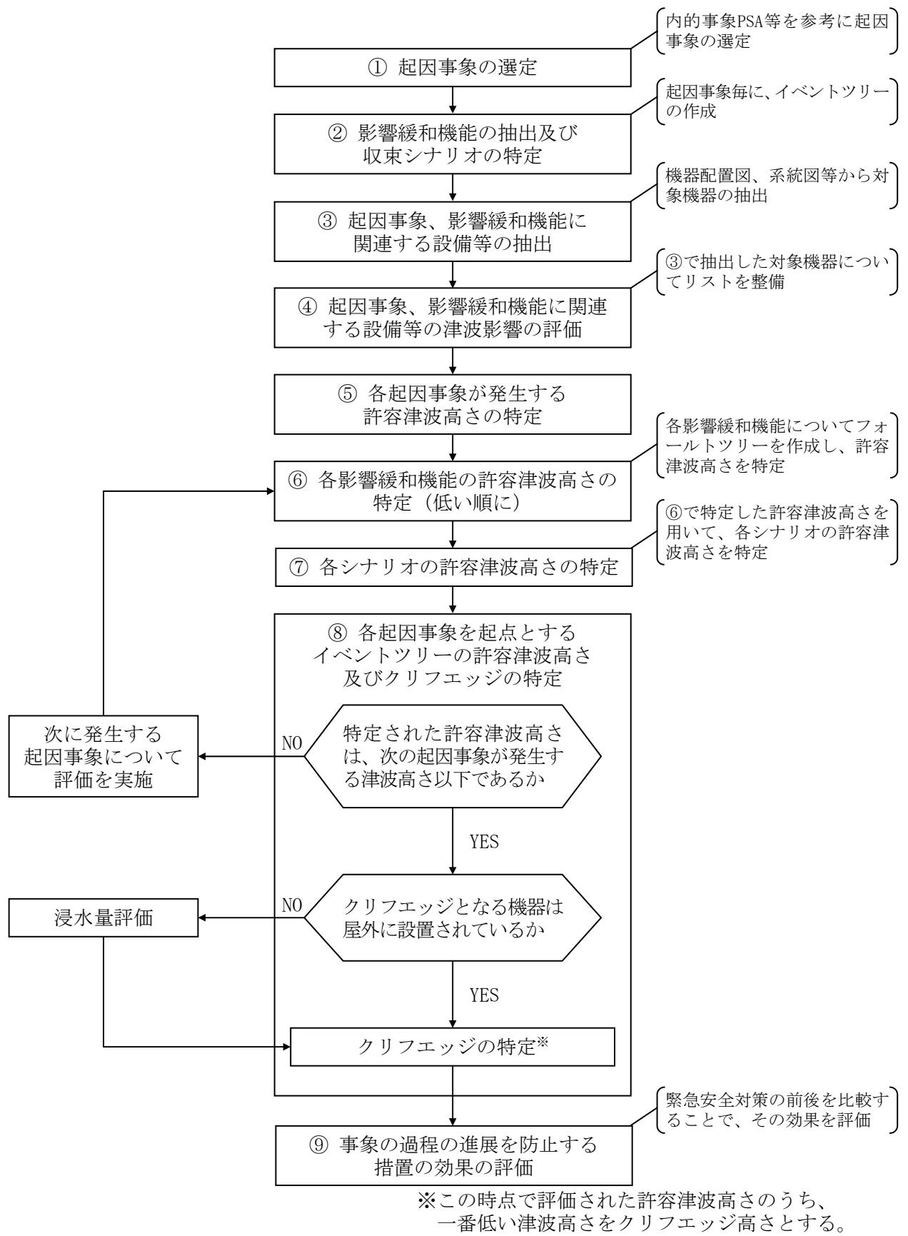
図5－2－1 クリフエッジ評価方法に係るフロー図（津波）
