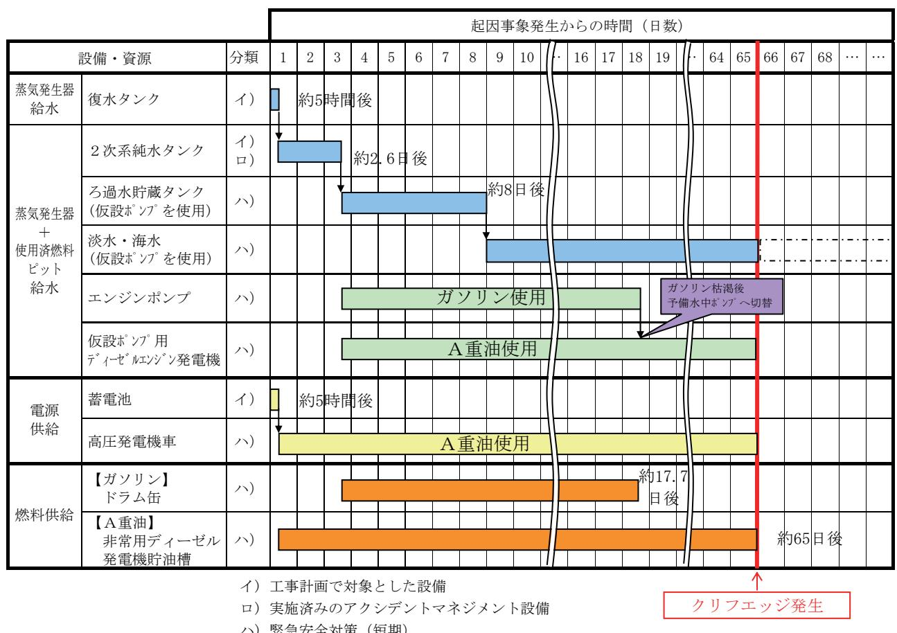
図5-4-4 プラント運転時の給水機能及び電源機能継続時間評価
