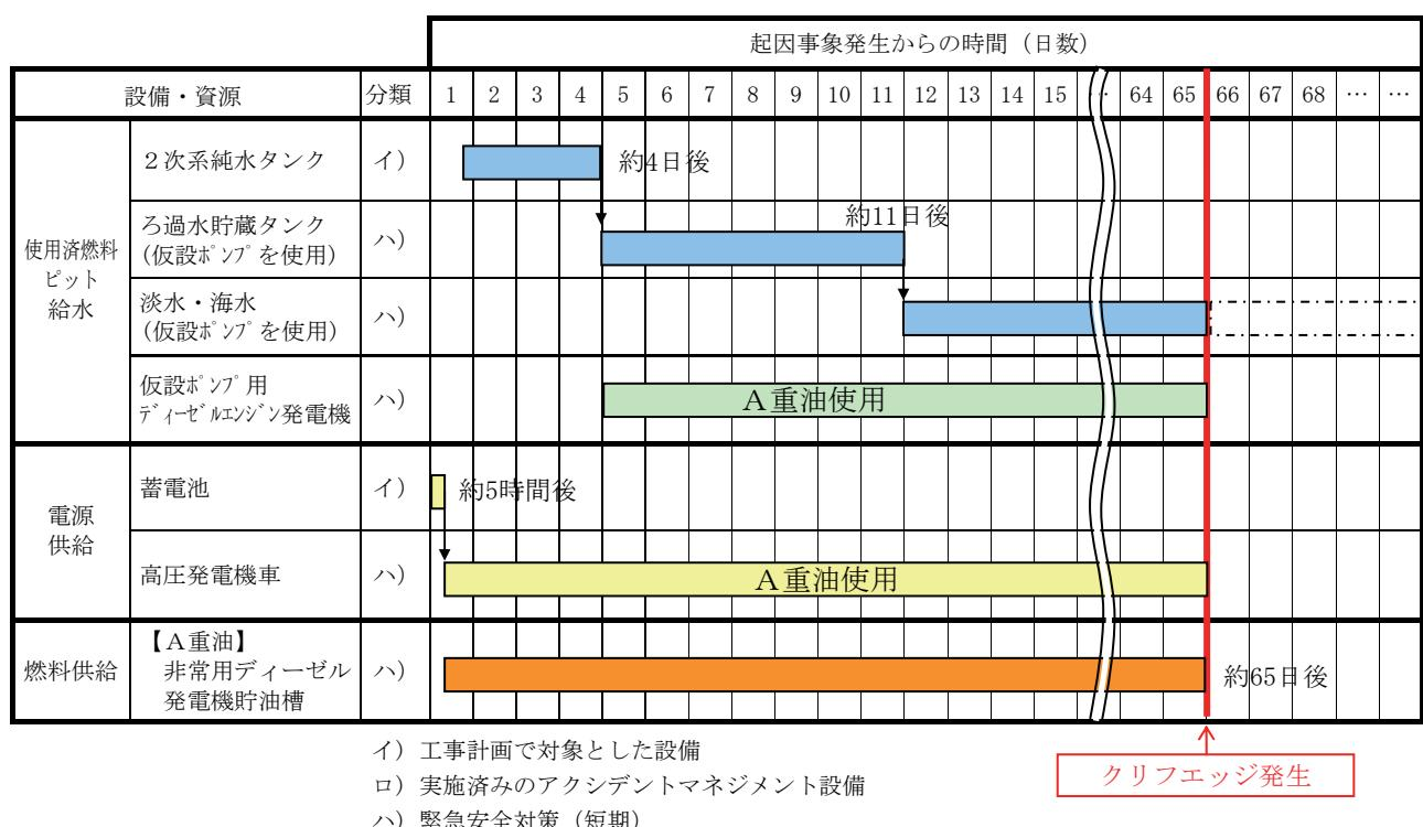
図5-4-5 プラント停止時の給水機能及び電源機能継続時間評価
