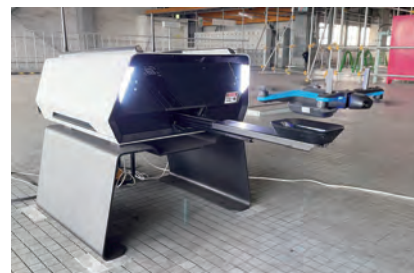
ドローンによる発電所の自動巡視点検を検証している。
