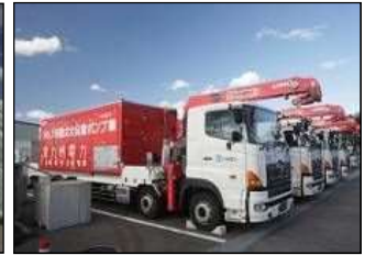
移動式大容量ポンプ車
