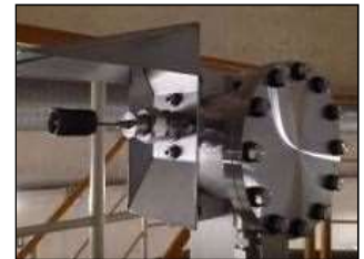
電気式水素燃焼装置
