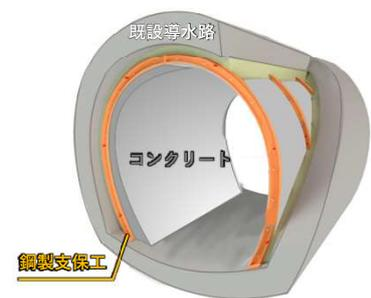
図3-9 導水路補強のイメージ
