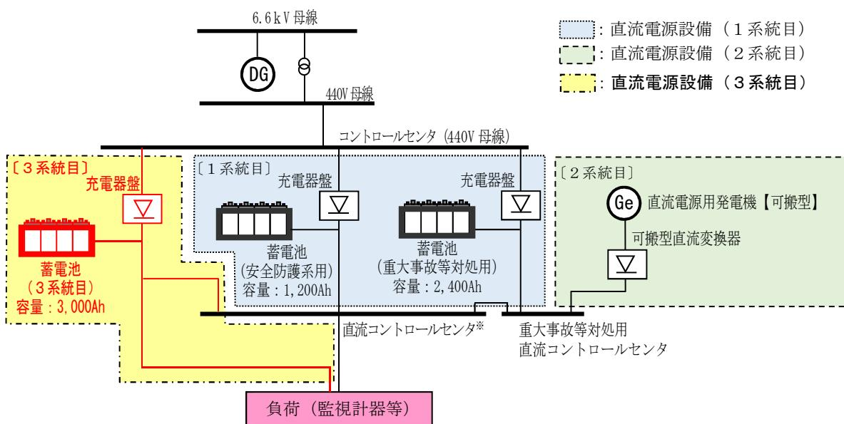
※: 直流コントロールセンタは、各号機毎にA系とB系があり、蓄電池（3系統目）は、いずれに対しても給電可能。
