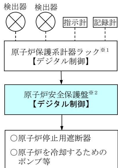
※1：プラントパラメータの異常を検知し、原子炉安全保護盤に異常信号を発信する。
