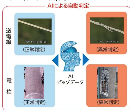
▲ AI及びビッグデータを活用した設備の異常判定
