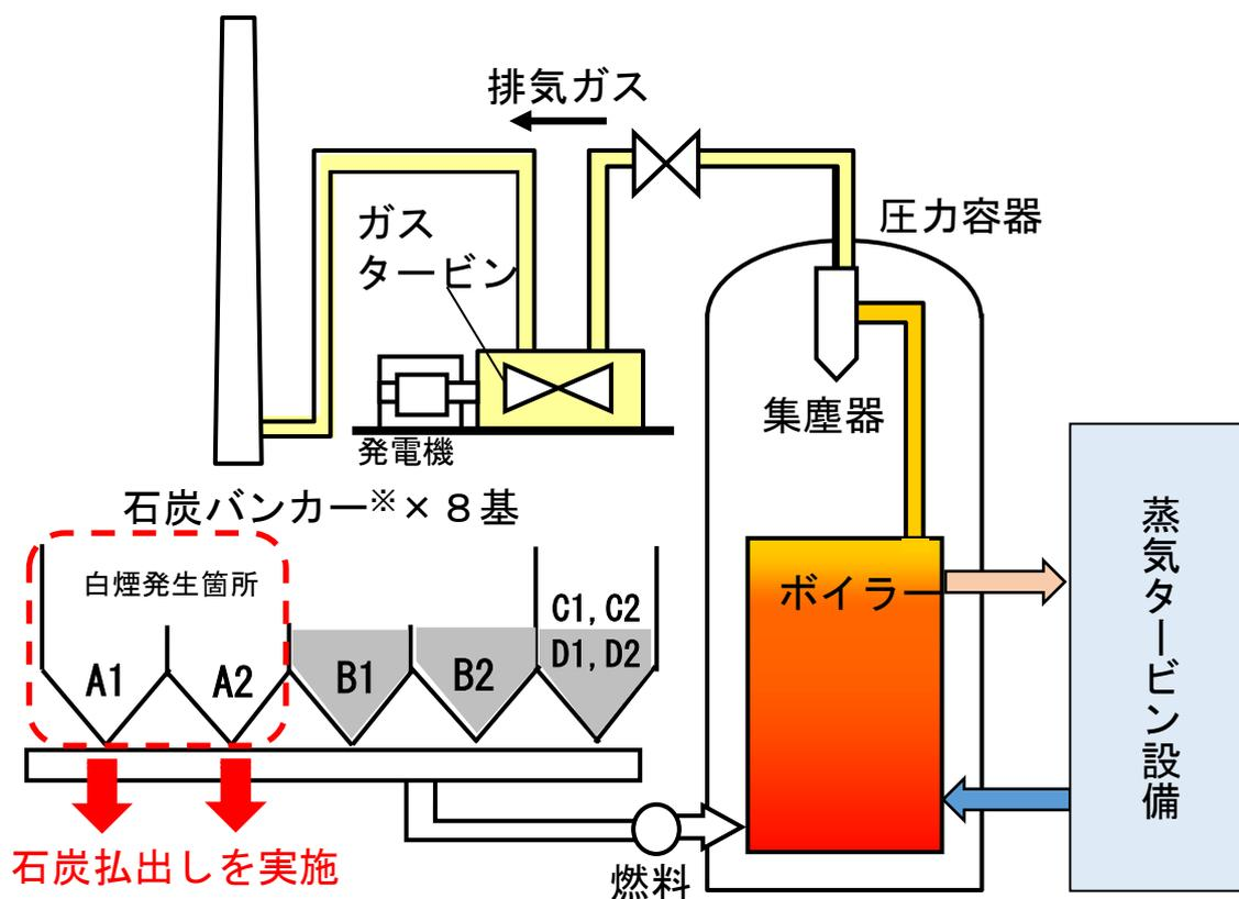
※石炭バンカー：ボイラーの燃料である石炭を貯める設備
