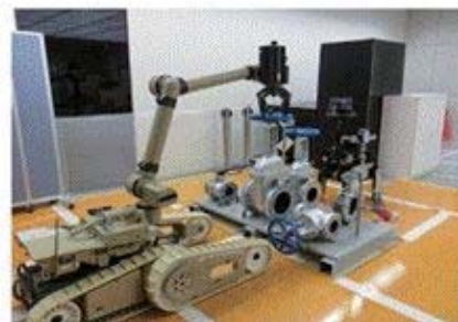
バルブの開閉操作
