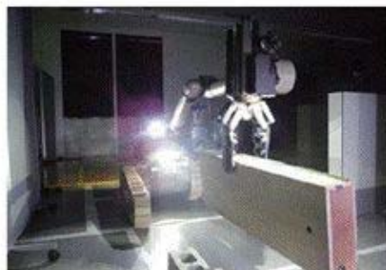
暗闇での障害物撤去
