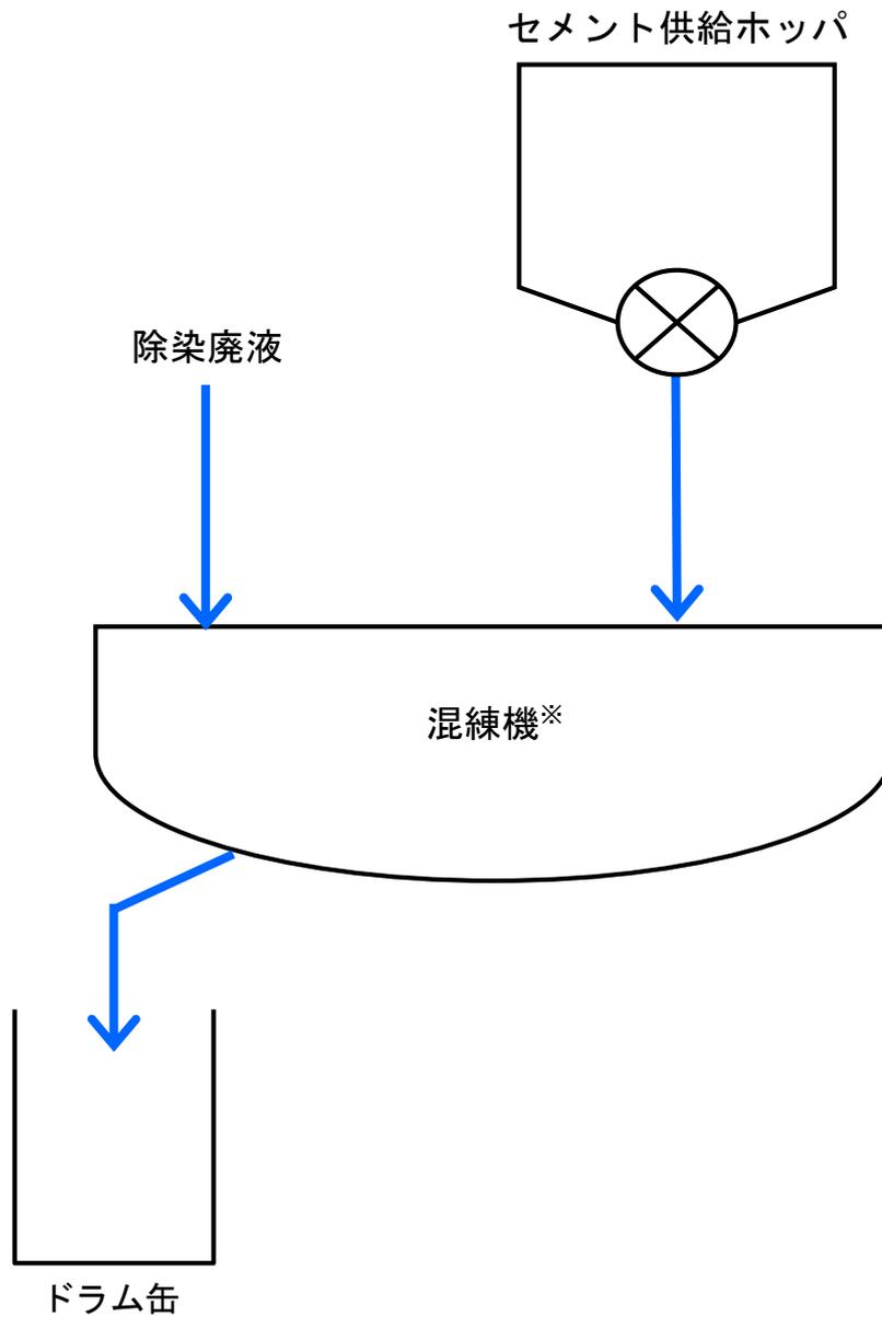
※ 管理区域で発生した除染廃液をセメントと混ぜ合わせ、セメント固化体を製造する設備
