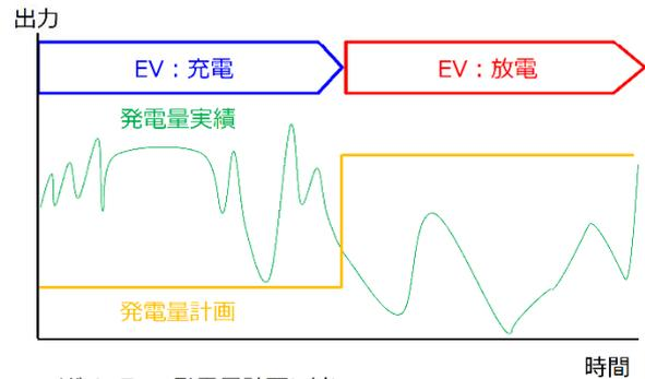
メガソーラーの発電量計画に対して、発電量実績が一致するようにEVの充放電を組み合わせる
