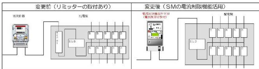
※分電盤を設置する際は、リミッタースペースのない分電盤の設置をお願いします。
