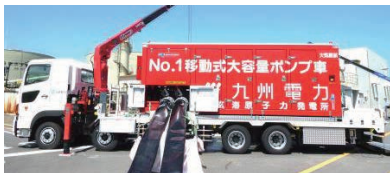
移動式大容量ポンプ車
