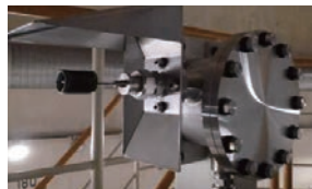
電気式水素燃焼装置
