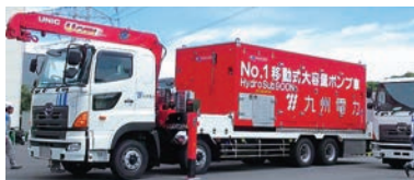
移動式大容量ポンプ車
