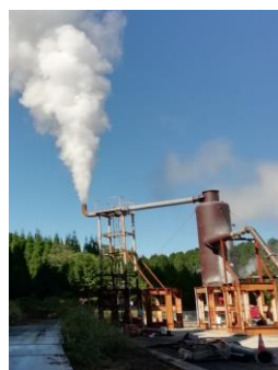
地熱発電所の新規開発に向けた地点資源調査 (左：資源確認のための掘削、右：蒸気等能力確認試験)
