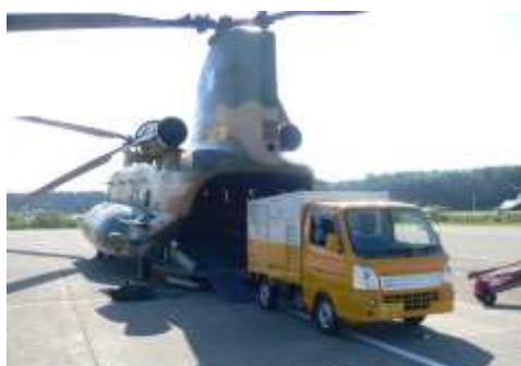
大型ヘリコプター（CH-47J）へ空輸対応型低圧応急用電源車「灯（ともす）」積載状況
