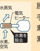
原子炉格納容器の冷却手段の多様化に加え、水素濃度の低減策として水素除去装置を配備。
