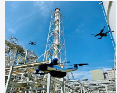
自律飛行型ドローンを活用したインフラ整備の自動巡回・点検サービス実証の風景
