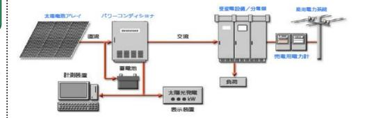
・太陽電池アレイで発電された直流電源は、パワーコンディショナーで交流電源に変換され受変電設備等に送られます。
