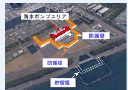
海水ポンプエリアの防水対策
