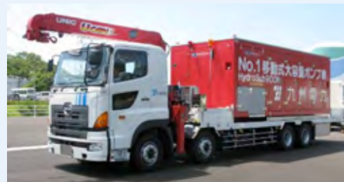
移動式大容量ポンプ車
