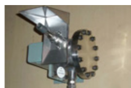
電気式水素燃焼装置
