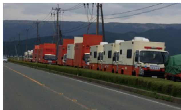
高圧発電機車による送電(関西電力(株))
