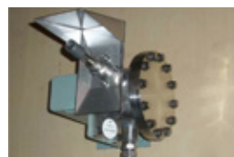
電気式水素燃焼装置
