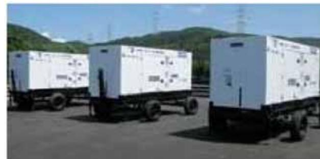
直流電源用発電機(可搬型代替電源)
