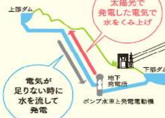
豊前蓄電池発電所(出力5万kW、容量30万kWh)
