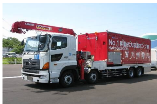
移動式大容量ポンプ車
