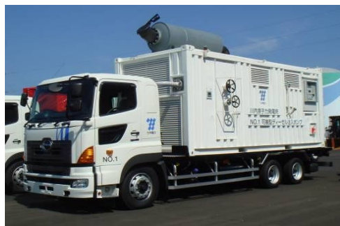
可搬型ディーゼル注入ポンプ
