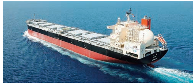
LNG燃料パナマックス型石炭専用船「苓明」(2023年11月竣工)
