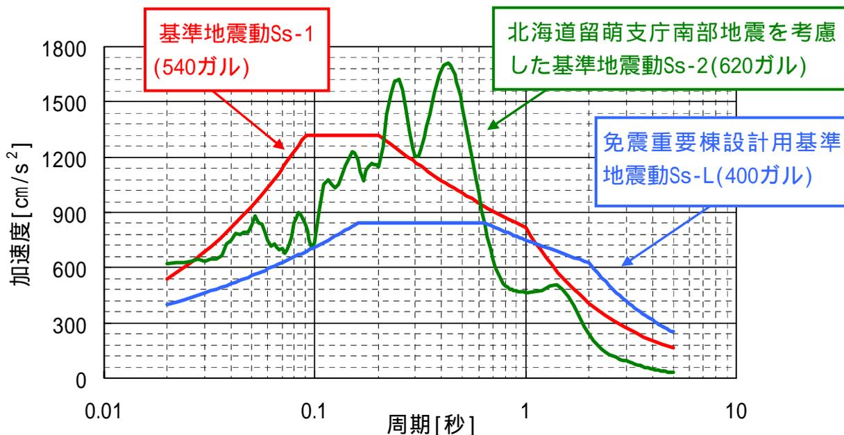
図 川内原子力発電所の基準地震動
