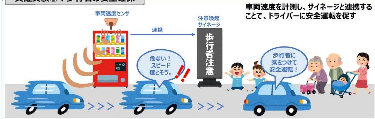
箱崎商店街沿道に設置した車両速度センサが、設定した速度を超過した車両の通行を検知した場合、道路沿いに設置したサイネージに安全運転を促すメッセージを表示します。
