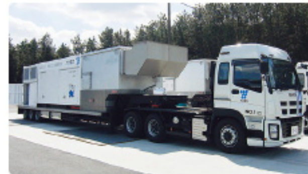
大容量発電機車
