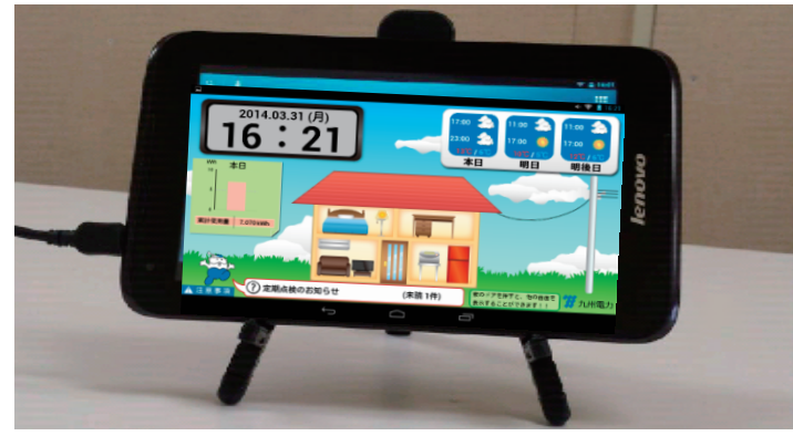
見える化端末（タブレット）サイズ：199×120×11(mm)
