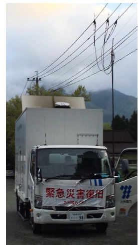
発電機車による送電
