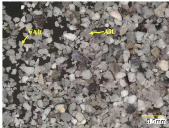
図3. 薩摩硫黄島 2024年9月1日火山灰の顕微鏡写真。デジタル顕微鏡(KEYENCE VHX-7100)により撮影。Altは大半を占める変質粒子、VAltは空隙を含むシリカ鉱物の粒子。LIBS元素分析はデジタル顕微鏡に設置したレーザーヘッド(KEYENCE EA-300)で実施した
