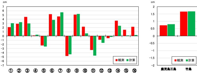
ダイクモデルによる各基線、鉛直変位における観測値と計算結果の比較
